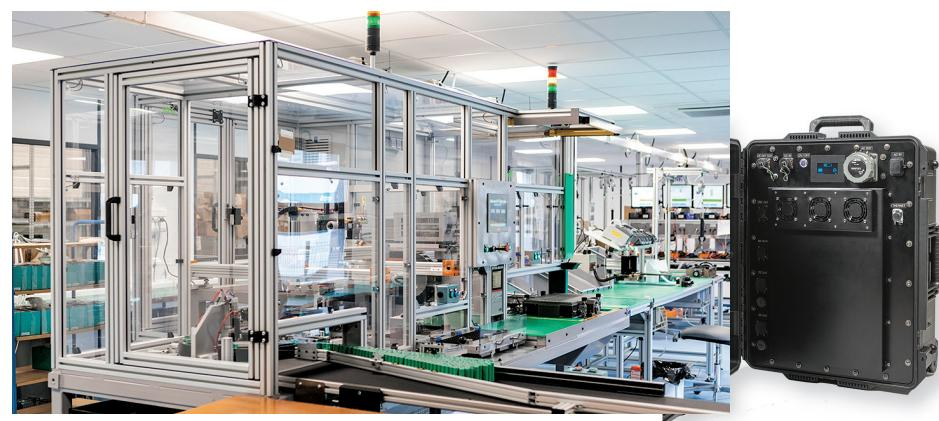
*"Le concept de nos valises est simple : capter l'énergie, la stocker et la restituer au bon format. Pour cela, nos valises d'énergie - ou d'éclairage - autonomes sont équipées d'une batterie lithium, elle-même dotée d'un système électronique appelé Battery Management System qui va superviser en permanence le fonctionnement des cellules lithium et assurer leur longévité et leur sécurité."*, explique Samuel Guillaume, Directeur Général de TecSup.
