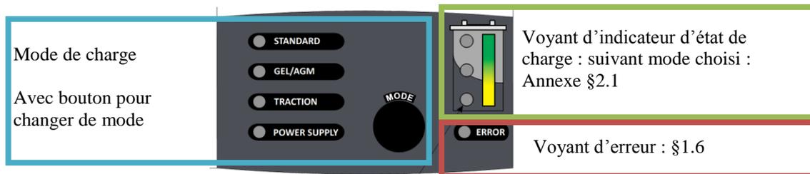
Dès la mise sous tension du chargeur, la led éclairée dans la partie « mode de charge » indique le mode de charge sélectionné. Le choix du mode d'utilisation (standard, GEL/AGM, traction ou power supply) s'effectue par l'appui successif de la touche « MODE »
