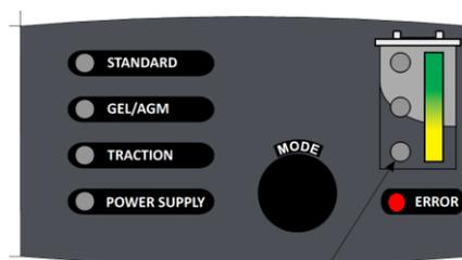
Si le voyant rouge est allumé, il faut vérifier l'installation et l'état de la batterie en cours de charge.
