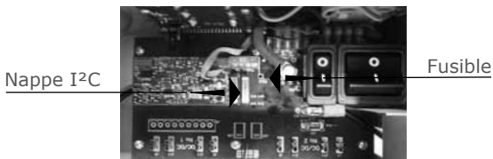
Localisation du connecteur I 2 C et du fusible changeable par le technicien de maintenance
